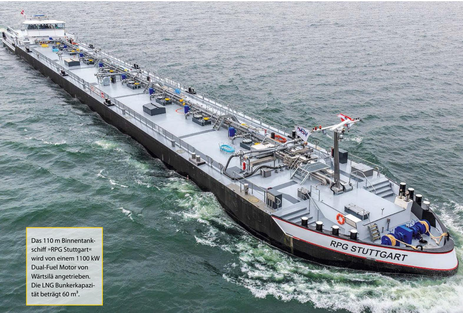
Das 110 m Binnentankerschiff »RPG Stuttgart« wird von einem 1100 kW Dual-Fuel Motor von Wärtsilä angetrieben. Die LNG Bunkerkapazität beträgt 60 m<sup>3</sup>.
